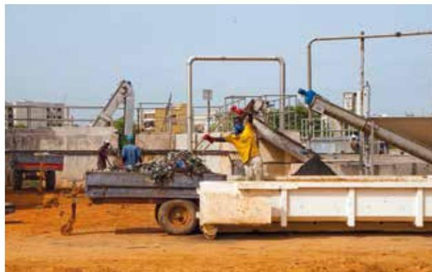
*Figure 11.1 : Un ouvrier de maintenance nettoie les dégrilleurs mécaniques ; cette activité essentielle doit être réalisée à chaque dépotage pour assurer le fonctionnement du système. Dakar, Sénégal (photo : Linda Strande).*
