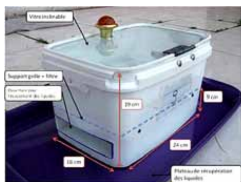
Mini-four solaire (vue extérieure).
